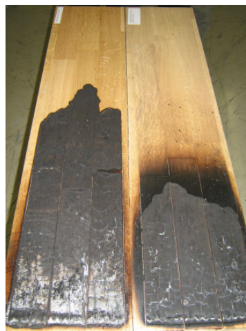
Testplatten, rechts mit LOBADUR WS Sealer
