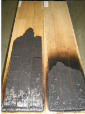
Testplatten, rechts mit LOBADUR WS Sealer
