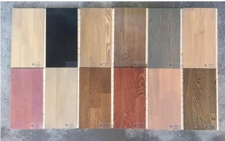
Die Tiefenwirkung, die wir als Belebung des Holzbildes wahrnehmen, entsteht durch unterschiedlich stark eindringende Flüssigkeit in das offenporigere Frühholz und das dichtere Spätholz. Das helle Frühholz wirkt dadurch transparenter, die Farbe des Spätholzes noch kräftiger. So entsteht ein stärkerer Kontrast in der Holzmaserung.
